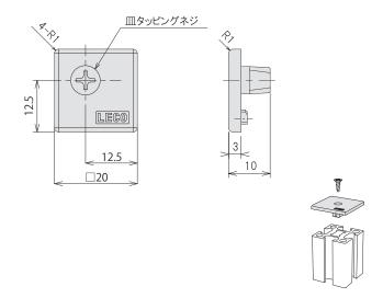
①ネジを差し込まずに軽く打ち込む。 ②挿入後ネジをねじ込んでください。
