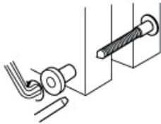
**特徴** 材質はダイキャストでブロンズメッキ。ジョイントコネクターボルトAタイプ(JCB-A)との組み合わせにより両方向からの締付けができます。
