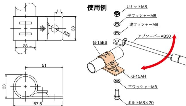
○写真はアブソーバーAB30(P90) 取付け時。
