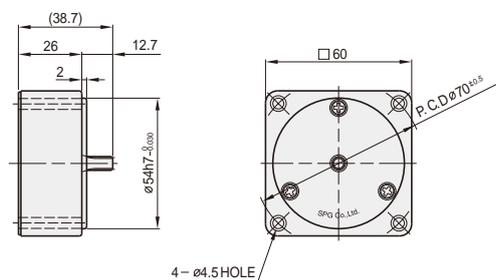
\* ギヤヘッド部 S6DA3B1(M)~18B1(M)の寸法、( )の値はS6DA20B1(M)~200B1(M)の寸法を表す。
