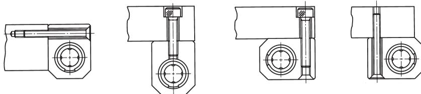
軸径3～40mmのアルミ製リニアハウジングで最も軽薄短小化された軸受箱シリーズです。リニアベアリングが1個入りのCHシリーズと2個入りのCHWシリーズがあり、防錆型リニアベアリング入りMシリーズ、Uウルトラシリーズもあります。また取付方法も自在性を持たせた設計がされています。
