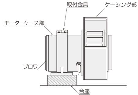
●取り付けには、台座などを設けてケーシング部が取付金具固定面と接触しないようにしてください。
