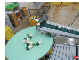
ライン末端のストックコンベヤ
