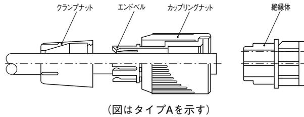
2. 各使用のケーブルのシース及び電線を下記の寸法で剥く。
