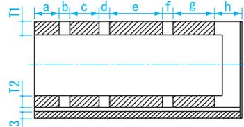
※斜線部分に対し、穴あけなどの追加加工が可能です。(但し吸着力は低下します。)
