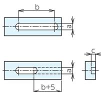
クランプユニット7110M、クランプユニット7110Nのクランプバーは交換が可能です。お客様にて製作される場合は以下の寸法を参考にしてください。
