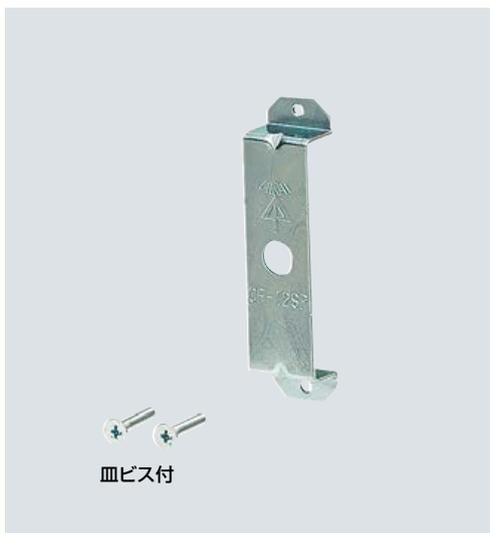
●高強度コンクリート等を打設する場合や打設深さが深くなる現場でのプラ塗代カバー変形防止に使用します。
