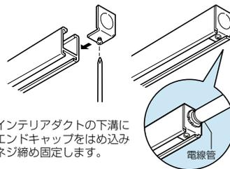
インテリアダクトの下溝にエンドキャップをはめ込みネジ締め固定します。
