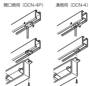
インテリアダクトの溝の中に金具を押し入れ、金具を90°廻し、ビス(M4)で、器具を固定します。
