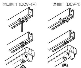
インテリアダクトの溝の中に金具を押し入れ、金具を90°廻し、蝶ナットで照明器具等を固定します。
