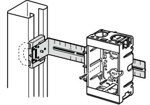
※押さえツバは、固定バー取り付け後、折り取ります。手でも折り取れます。
