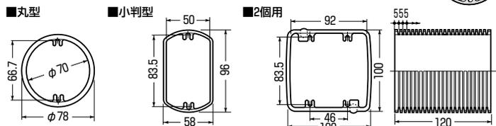
※適用：樹脂・金属製塗代カバー（平・塗代付）
