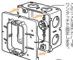
※塗代カバーを外す時は、(ー)ドライバーをツメの位置に差し、こじるようにして外してください。
