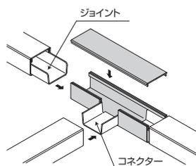
ベースにエムケーダクトを5mm程度離して接続し、カバーをはめ込みます。接続にはジョイント並びにコネクターをご使用ください。
