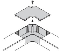
ベースにエムケーダクトを5mm程度離して接続し、カバーをはめ込みます。エムケーダクトのカバーは長さℓだけ切断してください。
