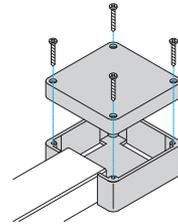
ベースにEMケータクトを突当て、カバーをビスで取付けます。複数方向へ分岐させる場合は、ベースのロックアウトを加工して使用します。
