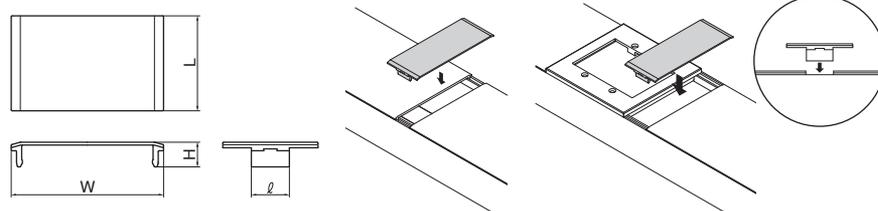
カバーに隙間がある場合に使用し、隙間部分のベースにはめ込みます。
