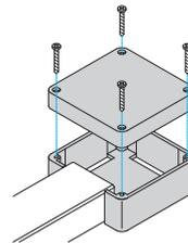
ベースにエムケーダクトを突当て、カバーをビスで取付けます。複数方向へ分岐させる場合は、ベースのノックアウトを加工して使用します。
