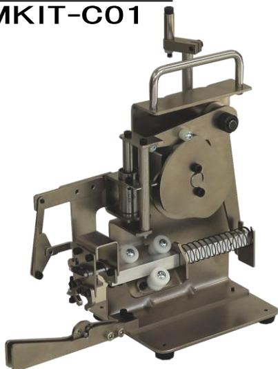
ピック&プレースユニットを組み立て、上部のハンドルを回すと動作します。メカで開閉するチャックで円盤形状の部品を掴み運びます。実際にカムの動きを見ながら、動作タイミングを理解することができ、また、自分で考えたモーションからカムを製作することもできるので、テキストを読むだけの学習ではなく、体験を通して学び理解を深められます。キットは分解し繰り返し組み立てられるので、複数人の教育も可能です。
