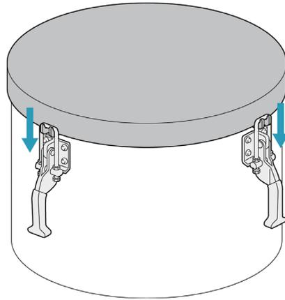
U型・フック型のバーにより固定物を引っ掛けてクランプします！特に機械部品・装置部品として採用いただいております。
