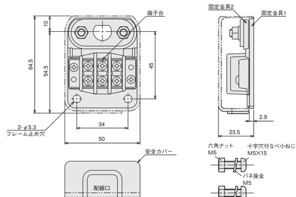
パワーモラーの取付軸の固定は3Nm、金具の固定は3.5Nmで締めつけてください。
