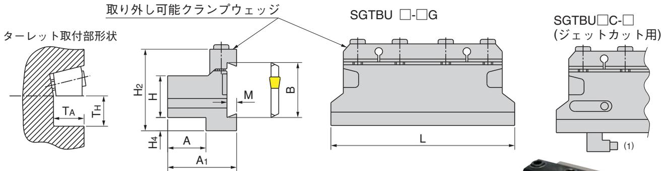
CGHN、TGHNブレードは、先端のボルト1本を緩めるだけでチップの交換が可能です。クランプウェッジが取外せます。
