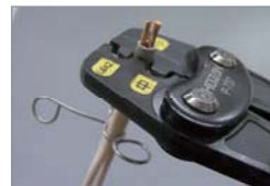
芯線被覆の端を揃えた状態を保持できるので、 慣れない方でも素早く、きれいに圧着作業を行うことができます。
