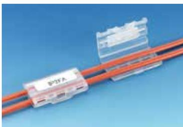
φ3mmの2心光コード用です。光コードを挟み込み、ワンタッチで取り付けができます。2段階操作で装着します。第1段階(仮止め状態)でケーブルに沿ってIP2FAを移動させ、第2段階(本止め)で適正な位置に固定します。このような2段階操作により、コードを傷める危険性が少なくなります。また、装着後も再利用が可能です。表裏の面に、手書きでコードの行き先を書き込んだり、TABTAGラベルをお使いいただき、ラベルを貼っていただくことも可能です。
