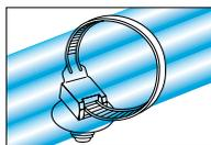
広い範囲の板厚に対応するファーツリーマウント形状のため、部品点数の削減に貢献します。パネル穴へ差し込んで固定する際、ハーネスを取り付け穴の真上で固定できるオンセットタイプです。OS170-FT7-LH、OS170-FT7-LH-HSWの「LH」は「Long Head」の意味で、結束工具で締め付け、切断をする際、バンドの切り残し部がヘッド内に収まるように設計されており、切れ端が残らず、より安全性に優れます。
