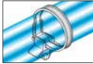
ウイング(支持翼) 付きタイプのプッシュマウントタイのオンセットタイプです。パネル穴へ差し込んで固定する際、配線を取り付け穴の真上で固定できます。また、結束後セレーションが外側に出るアウトサイドセレーションのため、被覆の柔らかい電線結束に適しています。
