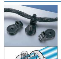
建設機械、重機、自動車などのスタッドボルトにねじ込んで固 定し、インシュロックタイを使用することで、油圧ホースや電 線の保持が可能です。金属製のクリップや針金をスポット溶接 する方法に較べ、大幅に美観が向上します。 ※スタッドボルトタイ、スタッドボルトマウントタイは、 P60~62をご参照下さい。
