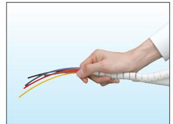
④ チューブ・電線、ジップラップをしっかりと押さえたまま、ラップ工具を手前に引いていくと、チューブ・電線は連続的に結束されていきます。
