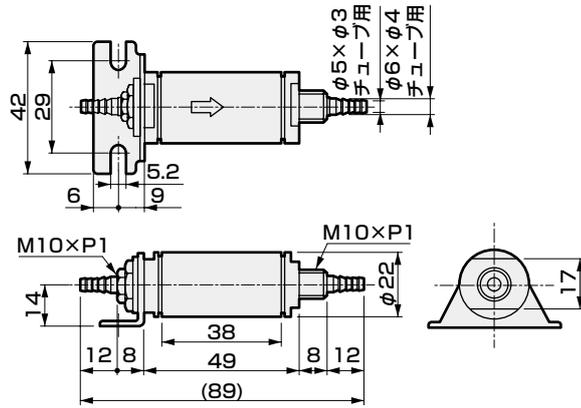
● 真空用フィルタハーフサイズ (ろ過度: 5 $\mu$ m)
