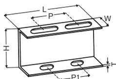
床配管、立て配管用の支持架台。
